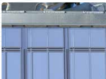
Le caisson lisse double peau alvéolée en alliage d'aluminium
