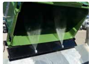
Laveur HP 140 bars 13 l/min avec cuve 400 l + rinçage
