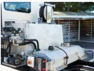
Laveur HP 140 bars 13 l/min + cuve 400 l
